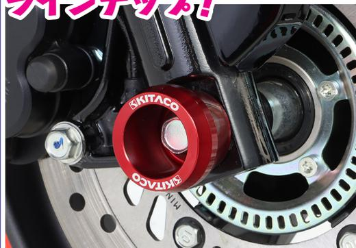
ノーマルアクスルシャフト及び、弊社中空アクスルシャフトに装着可能なアルミ削り出しアクスルプロテクター。万が一の転倒にアクスルシャフトをガード。転倒時の衝撃を車体を滑らせることでダメージを最小限に抑えます。
